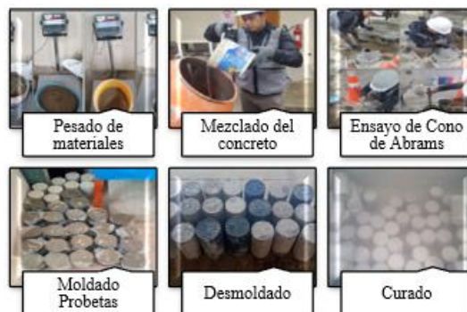
Fig. 4: Elaboración de probetas
