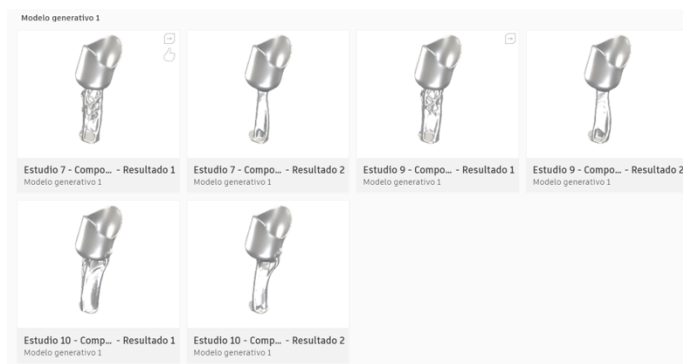
Fig. 8 Resultados del proceso de diseño generativo en Fusion 360
