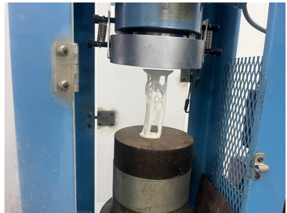
Fig. 15 Probeta ubicada dentro de la prensa Forney
