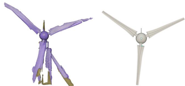
Fig. 3 Vista frontal del escaneo y del modelo CAD.
