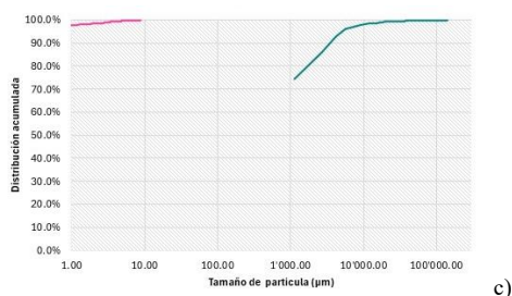
Fig. 5. Gráfico de distribución de tamaño de gota, para la Prueba 31 con Ai. a) Antes de aplicar CE. b) Después de aplicar CE. c) Comparación del antes y después de la aplicación del CE.
