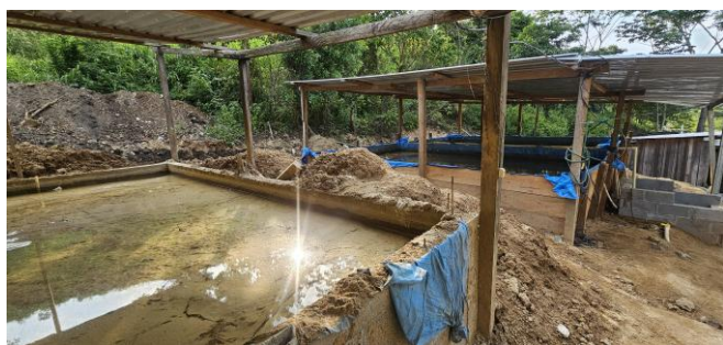
Fig. 2: Pilas de lixiviación artesanales ubicada en aldea Santa Cruz.
