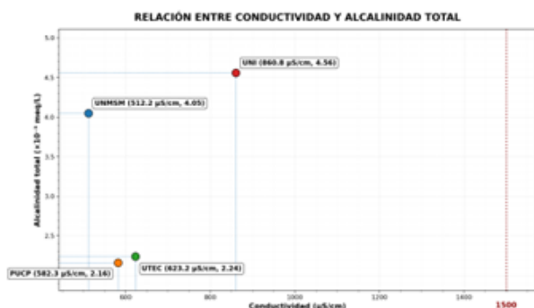
Figura 8. Relación entre la conductividad eléctrica y la alcalinidad total del agua en bebederos universitarios
