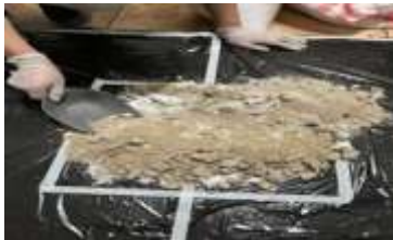
Fig. 4 Proceso de mezclado manual del mineral y la cal, simulando la operación realizada con cargador frontal en condiciones industriales.
