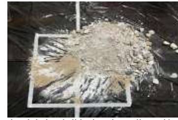
Fig. 5 Evidencia visual de la pérdida de cal por dispersión de partículas finas durante el proceso de mezclado.
