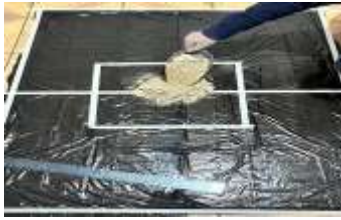
Fig. 2 Área de trabajo acondicionada para la simulación del proceso de mezclado de mineral y cal a escala reducida.
