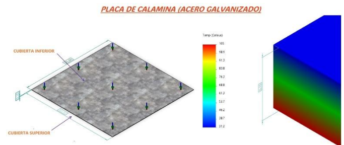
Fig. 7: Simulación “PLACA DE CALAMINA (ACERO GALVANIZADO)” con cara superior/inferior y escala de colores.).
