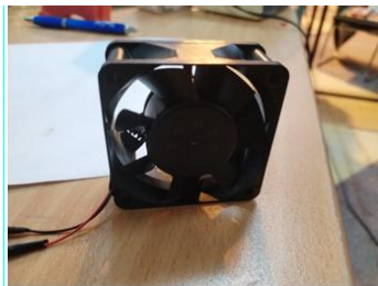
Fig. 2 Ventilador utilizado para convección forzada.
