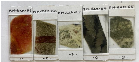
Fig. 6 Secciones delgadas para el estudio petrográfico, utilizadas para el análisis mineralógico y textural de las muestras bajo microscopio de polarización.
