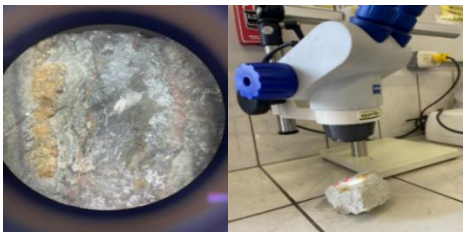
Fig. 5 Vista desde el Microscopio Estereoscopio Universal ZEISS, donde se aprecian características macroscópicas como color, morfología y rasgos texturales relevantes para la caracterización preliminar.
