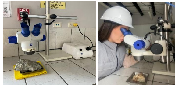
Fig. 1 Microscopio Estereoscopio Universal ZEISS, utilizado para la observación macroscópica de muestras de mano, permitiendo reconocer características morfológicas, texturales y estructurales preliminares.
