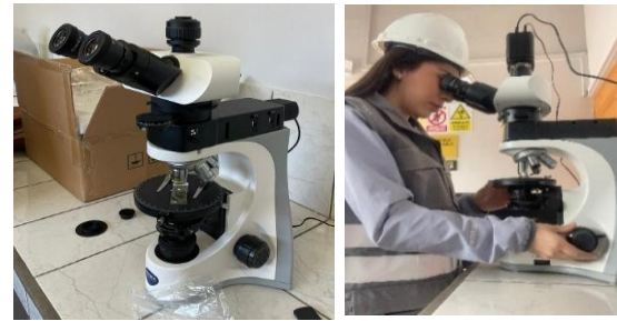
Fig. 2 Microscopio Trinocular De Polarización OPTIKA B-510POL-I, utilizado para el análisis de propiedades ópticas, identificación mineralógica y caracterización textural de las muestras.
