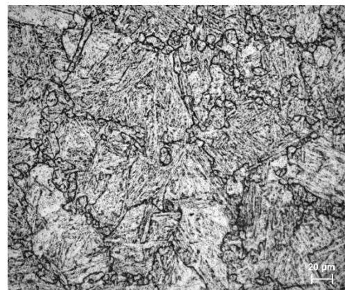
Fig. 1 Fotomicrografía óptica del acero martensítico-ferrítico ASTM A335 grado P91. Microestructura de martensita revenida.
