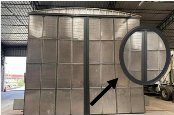
Figura 6 hermetización de la cabina
