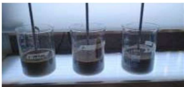
Fig. 2 Muestras de lodos activados durante la prueba de jarras
