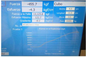
Fig. 6 Resultados de resistencia en la máquina Forney al espécimen de ladrillo
