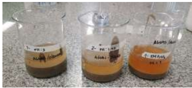
Fig. 3 Muestras de lodos activados después de la prueba de jarras
