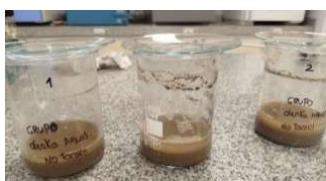
Fig. 1 Sedimentación de lodos después de prueba de jarras
