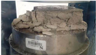
Fig. 5 Prueba de resistencia al ladrillo elaborado con lodos activados de la PTAP
