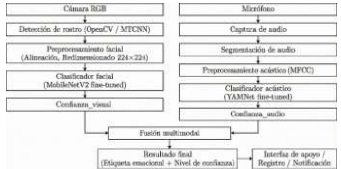
Fig. 2 Diagrama de bloques del pipeline multimodal del sistema.
