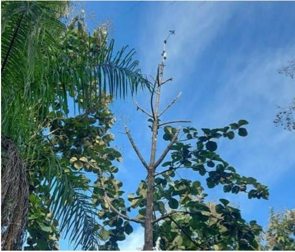
Fig. 4 Anemómetro Davis 6410 instalado en Limonal, Guanacaste, Costa Rica
