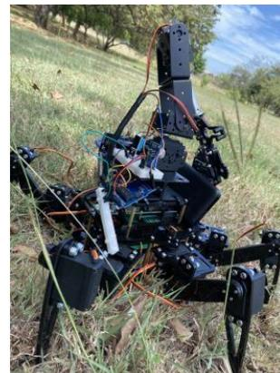
Fig 6. Robot hexápodo (v2) terminado. Fuente propia
