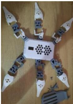
Fig 3. Piezas del robot hexápodo (v1). Fuente propia
