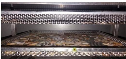
Figura 4. Secado convectivo de las semillas de lúcuma
