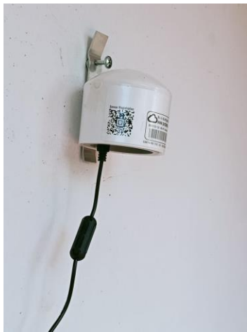
Fig. 2. Instalación del contador óptico de partículas de bajo costo, sensor Purpleair
