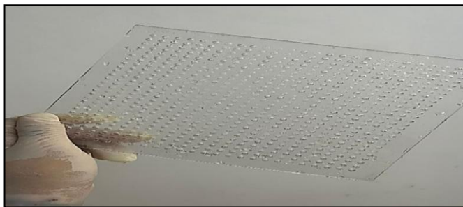
Fig. 6 Rejilla de divisora de cada filtro. Nota. Divisor de acrílico con agujeros de 0.5 mm.
