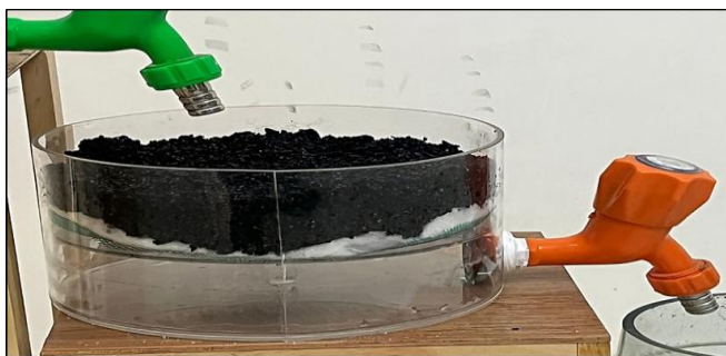
Fig. 8 Prototipo de la última fase con rejilla divisora, malla de micrón, algodón y carbón activado.
