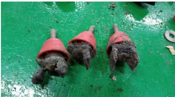
Fig. 4 Soporte de riel deteriorado
