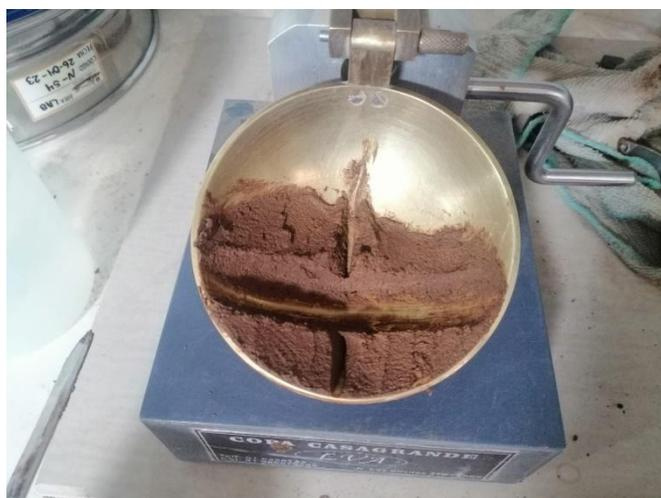
Fig. 3. Extracción de la muestra húmeda de límite líquido en la copa de Casagrande (Suelo100)
