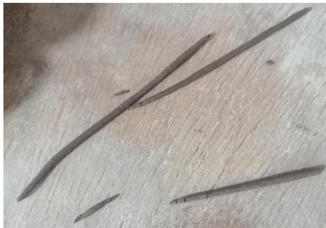
Fig. 4 Muestra del Ensayo de límite plástico (Suelo100)
