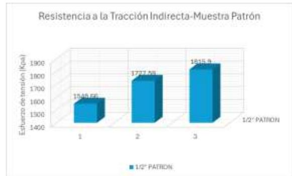
Fig.6 Resultados gráficos obtenidos del ensayo de resistencia a la tracción en especímenes de concreto convencional.
