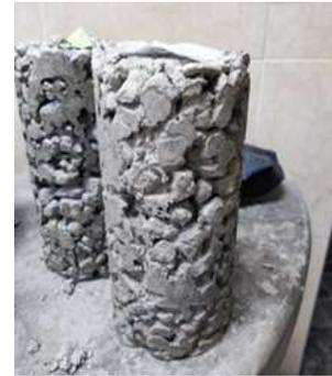
Fig.9 Imagen referencial de las muestras utilizadas con agregado de 3/4\"/>
