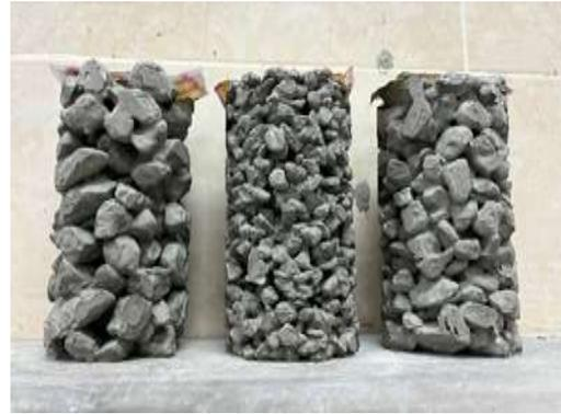
Fig.8 Imagen referencial de las muestras utilizadas con diferentes tamaños de agregados 3/4\"/>
