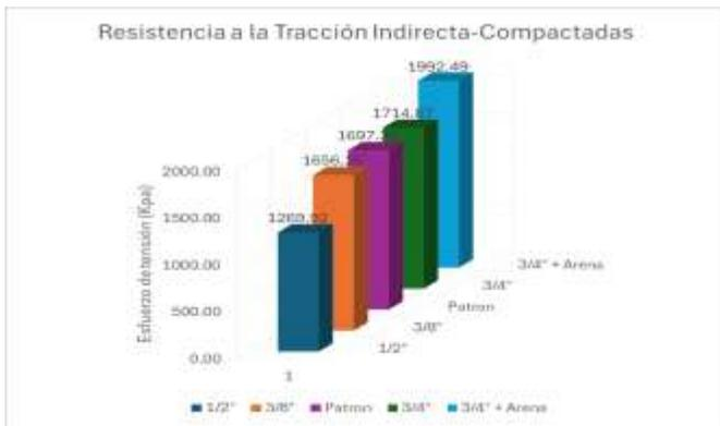
Fig. 4 Resultados gráficos obtenidos del ensayo de resistencia a la tracción en especímenes compactados y la muestra patrón.
