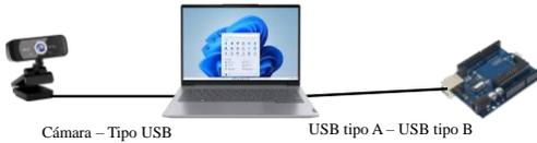
Fig. 7 Conexión en prueba individual
