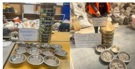
Figura 3 Granulometría de agregado fino y agregado grueso
