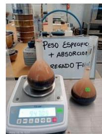
Figura 4 Peso específico y absorción de material fino
