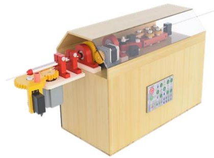
Fig. 7 Modelo conceptual de una máquina dobladora de alambres impreso en 3D. [15]
