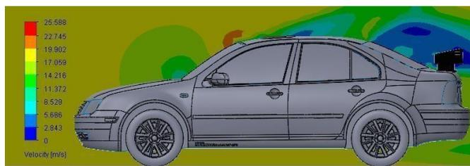
Figura 10. Simulación con alerón de la fuerza aerodinámica
