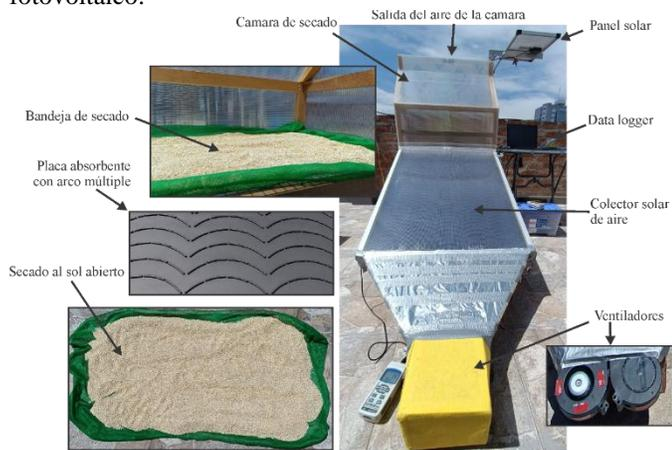
Fig. 2 Configuración experimental del secador solar mixto.
