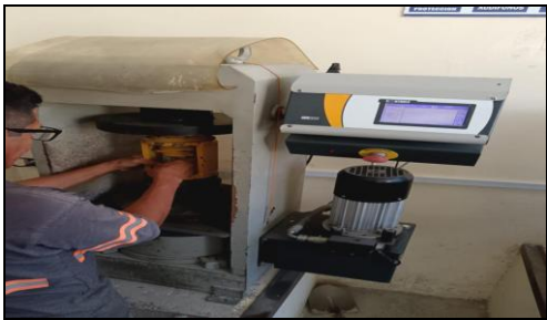
Fig. 4 Preparación de la muestra para prueba de resistencia.
