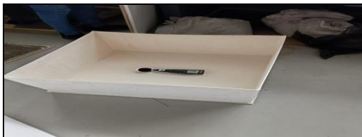
Fig. 8 Caja reverberante sin capa de mortero modificado
