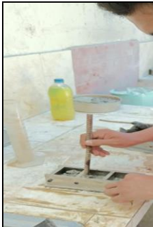
Fig. 3 Colocación del mortero en los moldes.
