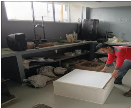
Fig. 6 Caja reverberante utilizada para la prueba acústica.
