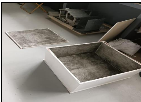
Fig. 7 Caja reverberante con la capa de mortero modificado.
