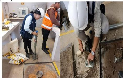
Fig. 04 Compactando y enrasando las muestras
