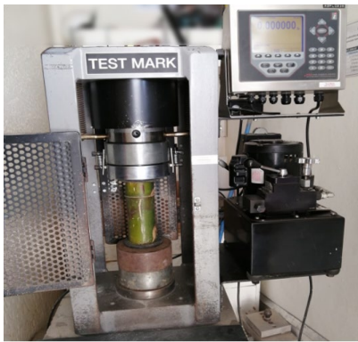
Fig. 7 Ensayo a compresión de las muestras bambú para estudio.
