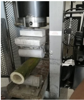
Fig. 9 Ensayo a flexión de piezas de bambú con máquina universal de compresión debidamente adaptada.
