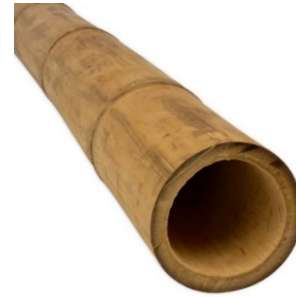
Fig. 3 Sección transversal anular de una pieza de bambú.
