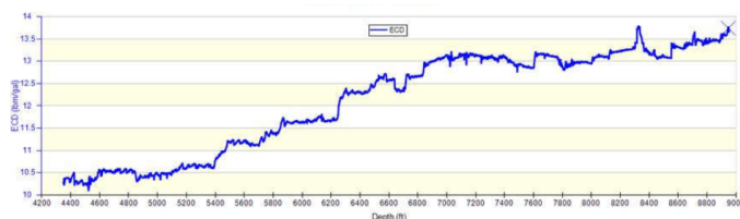
Figura 11. Perfil de la densidad equivalente de circulación. Para el cálculo de la densidad equivalente de circulación no modelaron los efectos causados por la concentración de sólidos.
