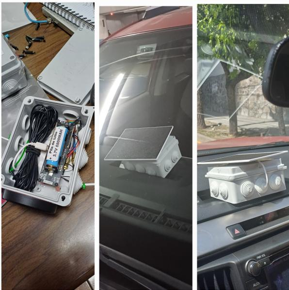
Fig. 3: Prototipo del Nodo IoT del sistema propuesto.
