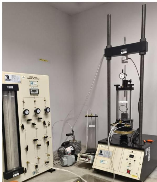
Fig. II Equipo triaxial
