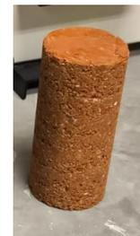
Fig. VIII Testigo para triaxial
