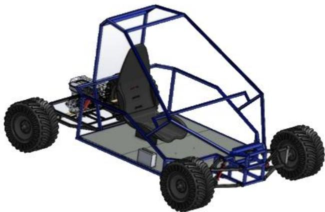
Fig. 3 Ensamble completo del buggy
