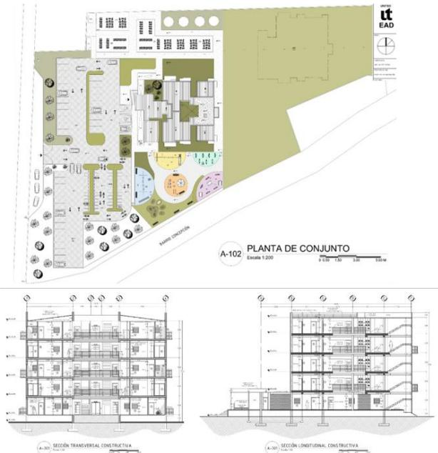
**Fig. 6** Visualización de planta de conjunto y secciones de las torres.
