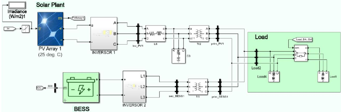
Fig. 1. Modelo de la microrred en modo aislado.
