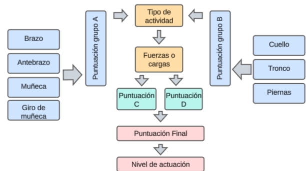
Fig. 4 Esquema de proceso de puntuación para el método RULA
