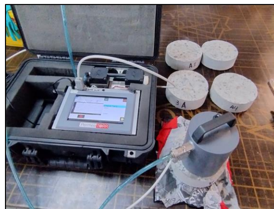
Fig. 5. Uso del Permeabilímetro de Torrent en concreto
