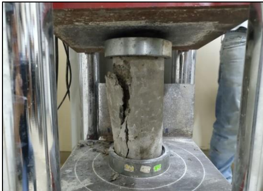
Fig. 6. Ensayo de resistencia a la compresión en concreto a 360 días
