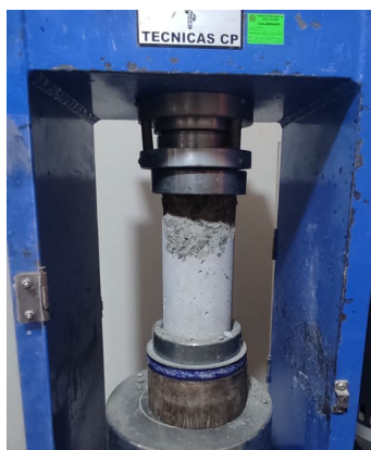
Fig. 4 Rotura de probetas de concreto.
