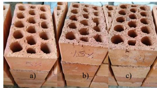
Fig.7 a) Ecoladrillo con 5% GCR, b) Ecoladrillo con 15% GCR, c) Ecoladrillo con 25% GCR.
