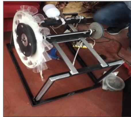
Fig.7 Prototipo Generador con turbina tipo Pelton. Fuente propia.
