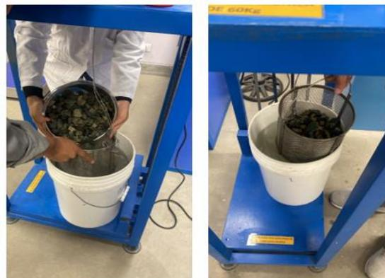
Fig. 10. Peso específico y absorción de agregado grueso. (Elaboración propia)
