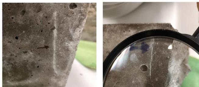
Fig. 13. Fotografías de grietas autorreparadas con *Bacillus subtilis* mediante la precipitación de calcita. (Elaboración propia)
