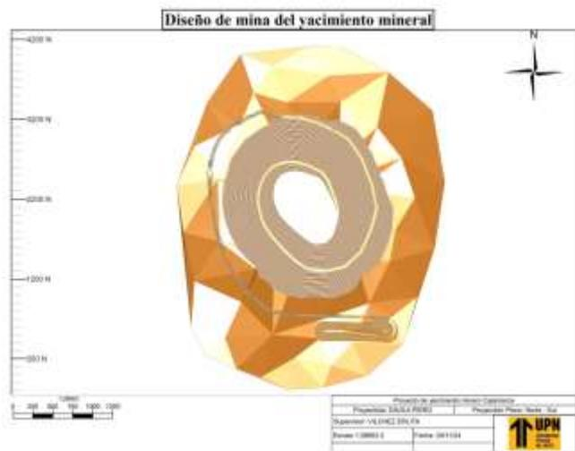
Fig.8 Diseño del Pit Óptimo aplicando Geoestadística.
