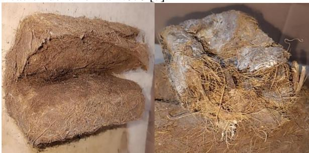
Fig. 8 - Carencia de resistencia para la aplicación de ensayos mecánicos en los bloques de fibra de coco más adición de resina.
