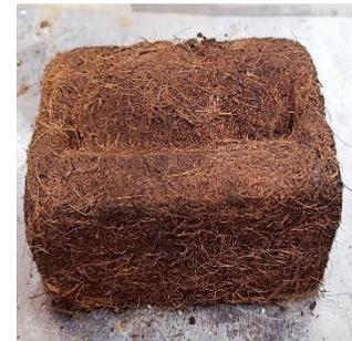
Fig. 7 - Bloques de fibra de coco más adición de resina, en su proceso de secado a la intemperie.
