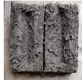
Fig. 6 - Bloques de fibra de coco más adición de cal viva, en su proceso de secado a la intemperie.
