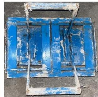
Fig. 1 - Molde metálico de bloque prefabricado
