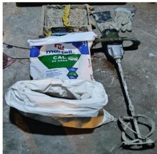
Fig. 4 - Empleo de mezclador mecánico con mezcla con cal viva
