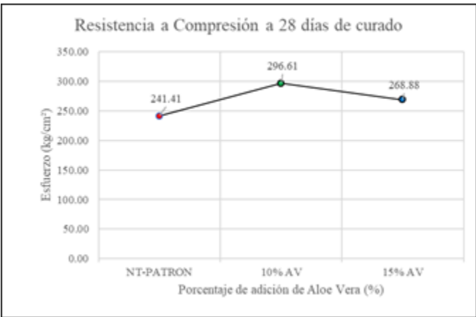
Fig. 5 Resistencia a la compresión del concreto f'c=210\text{kg/cm}^2 con la adición de 10% y 15% de aloe vera a las diferentes etapas de curado
