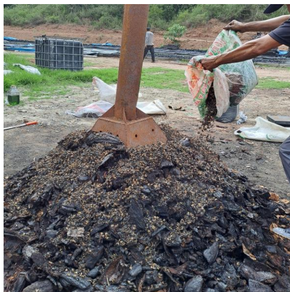
Fig. 1 Proceso de carbonización de los residuos (café/cacao) mediante el método de campana.
