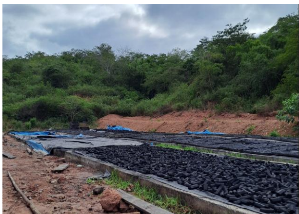
Fig. 5 Etapa final de secado de los extruidos de carbón.
