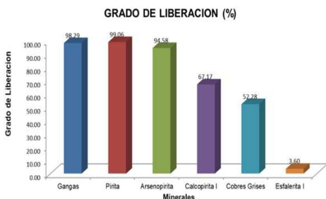
Fig. 6 Distribución mineralógica de la muestra, según grado de liberación.
