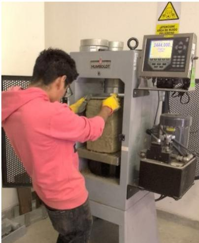
Fig. 7 Ensayo de compresión de pila de adobe
