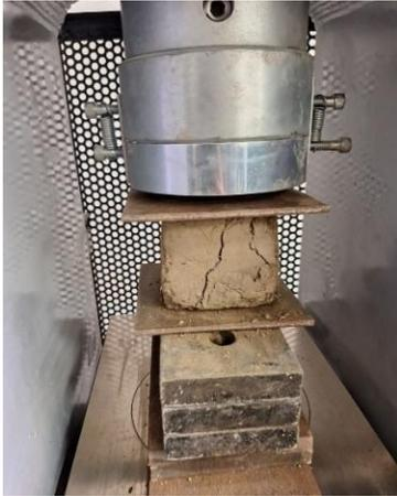
Fig. 6 Ensayo de compresión de cubo de adobe
