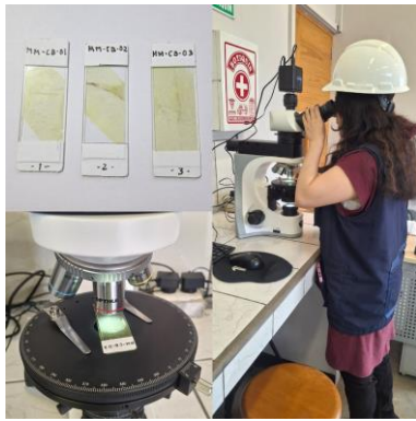
Figura N° 4: Superior Izquierda: Muestras de Arenisca en laminas delgadas. Inferior Izquierda: Lamina delgada de Arenisca puesta en la platina del equipo. Derecha: Muestra en lámina siendo observada.
