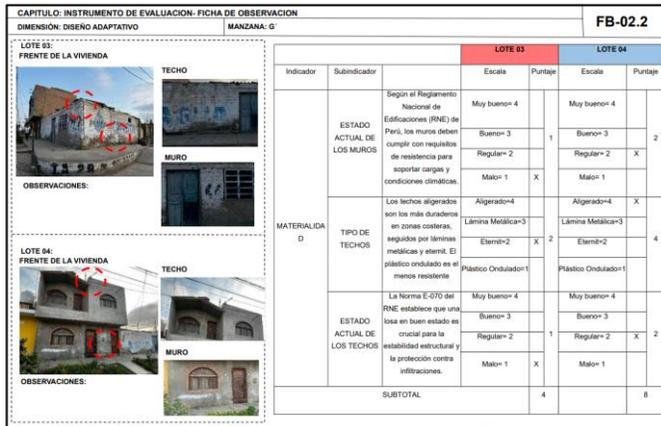
Fig. 3 Ficha de observación de estado de los elementos estructurales por lote.
