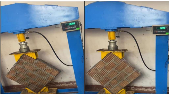
(a) Esfuerzo máximo murete con geomalla uniaxial (b) Esfuerzo máximo murete con geomalla biaxial
