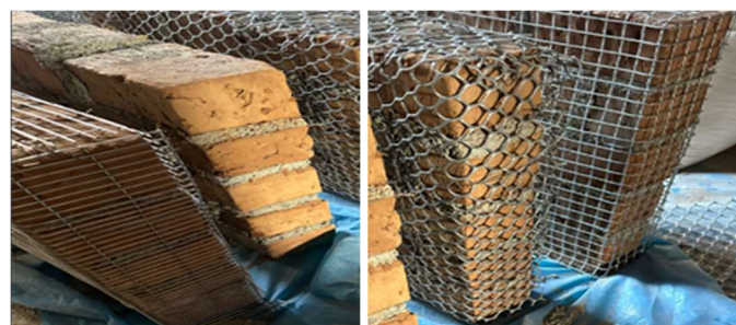
(b) Murete con geomalla uniaxial y de patrón (a) Murete con geomalla biaxial y electrosoldada
