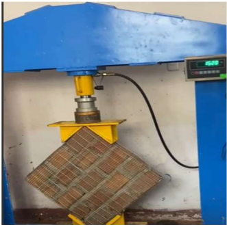
(c) Esfuerzo máximo murete con malla electrosoldada
