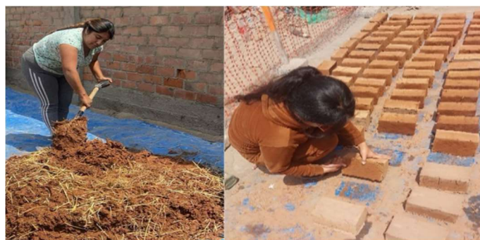
(a) Mezcla de arcilla, paja y agua (b) volteado de bloques para culminar con el secado
